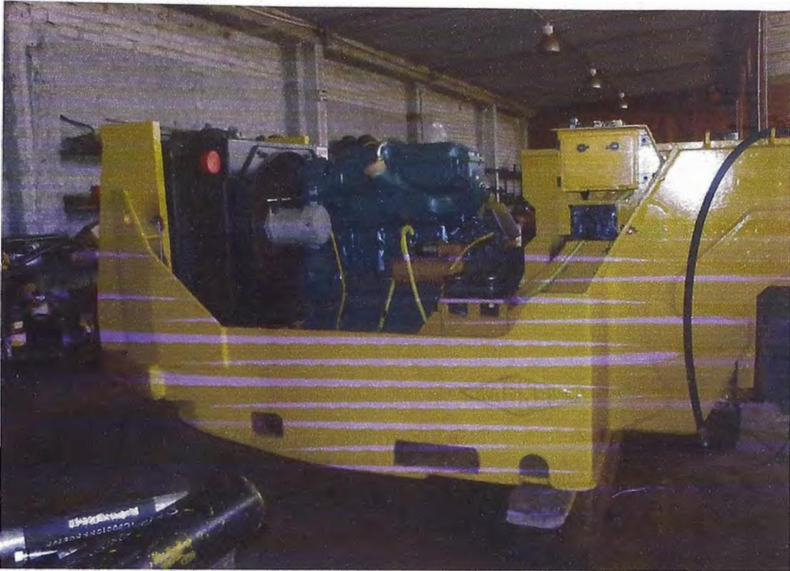
Figura 6.7: Chasis posterior de scoop repotenciado
