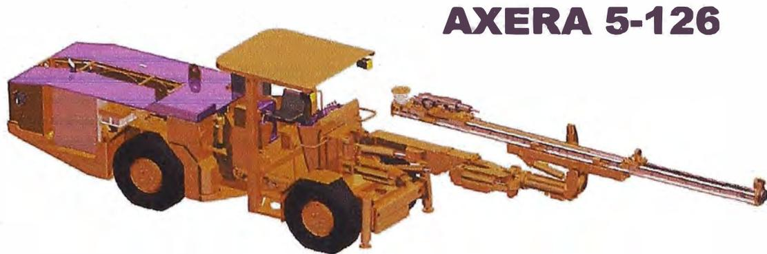
Figura 2.3: Jumbo Axera5 -126 de un brazo Sandvik.
