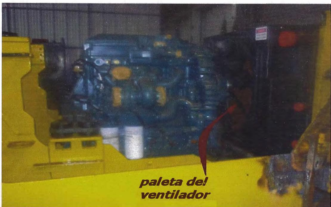
Figura 6.4: Ventilador de motor diesel del scoop repotenciado.
