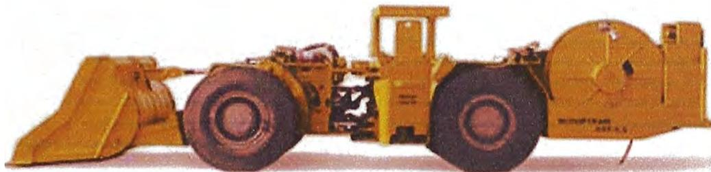
Figura 2.2: Scoop Eléctrico de 3.5 yd<sup>3</sup> de Atlas Copco.
