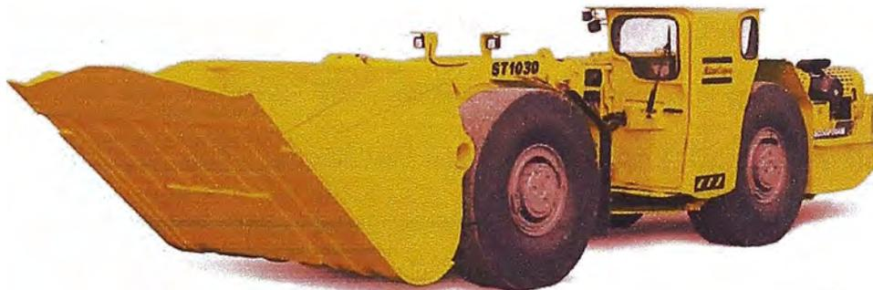
Figura 2.1: Scoop Diesel de 6.5 yd<sup>3</sup> de Atlas Copco
