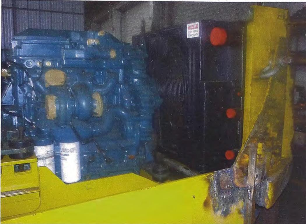
Figura 6.3: Radiador del motor diesel de scoop repotenciado.
