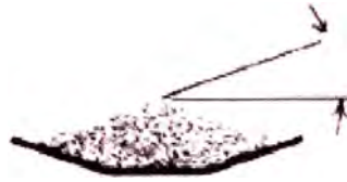
Figura 2.5 Ángulo de sobrecarga
