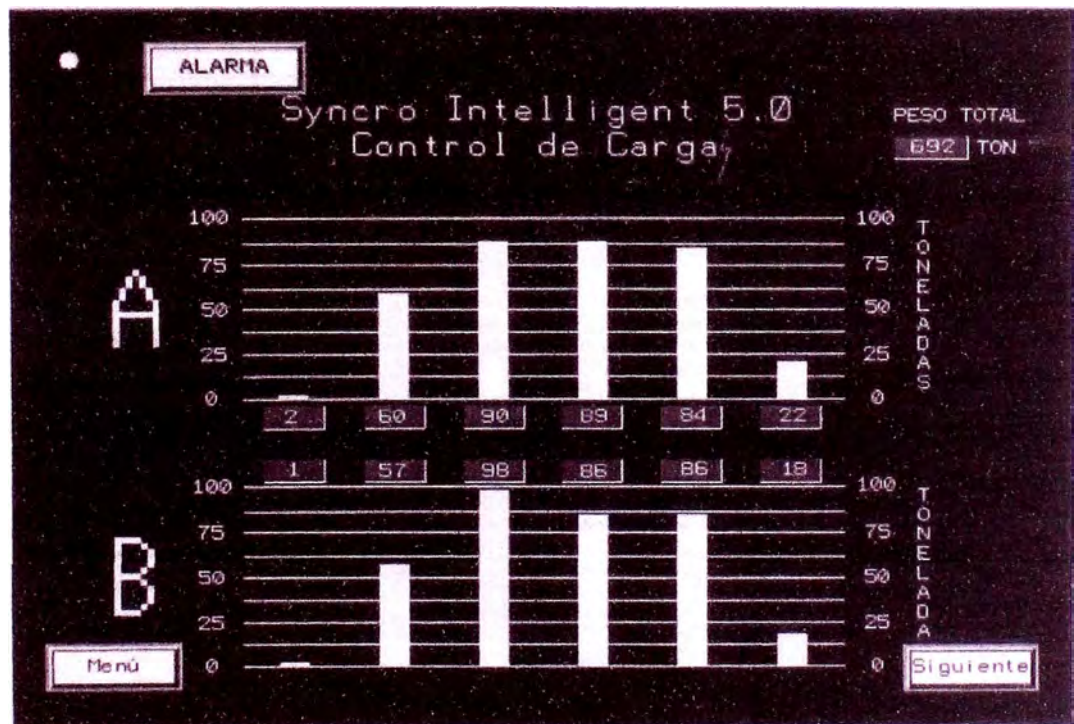
Figura 3.21: Reporte de pesos en los winches del syncrolift a babor y estribor de la embarcación en estudio.
