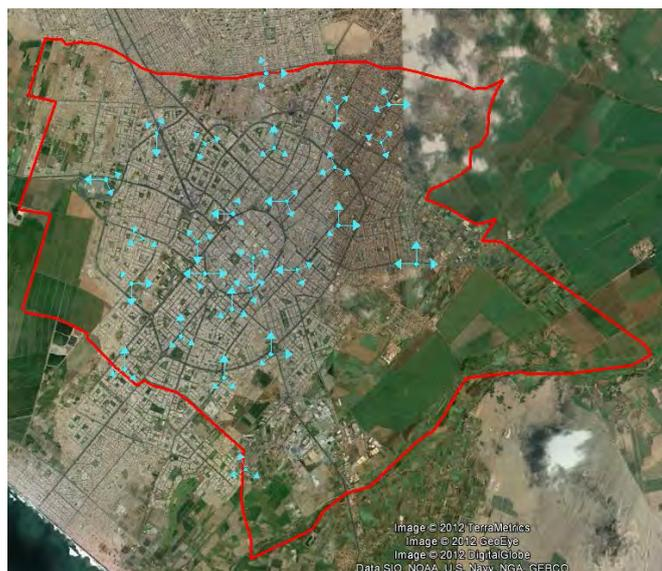
Figura 4.8 Ubicación de los NBs instalados por Claro en el distrito de Trujillo.
