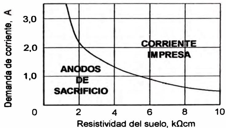
Fig. 3.2 Campos de aplicación de protección catódica con corriente impresa y ánodos de sacrificio
