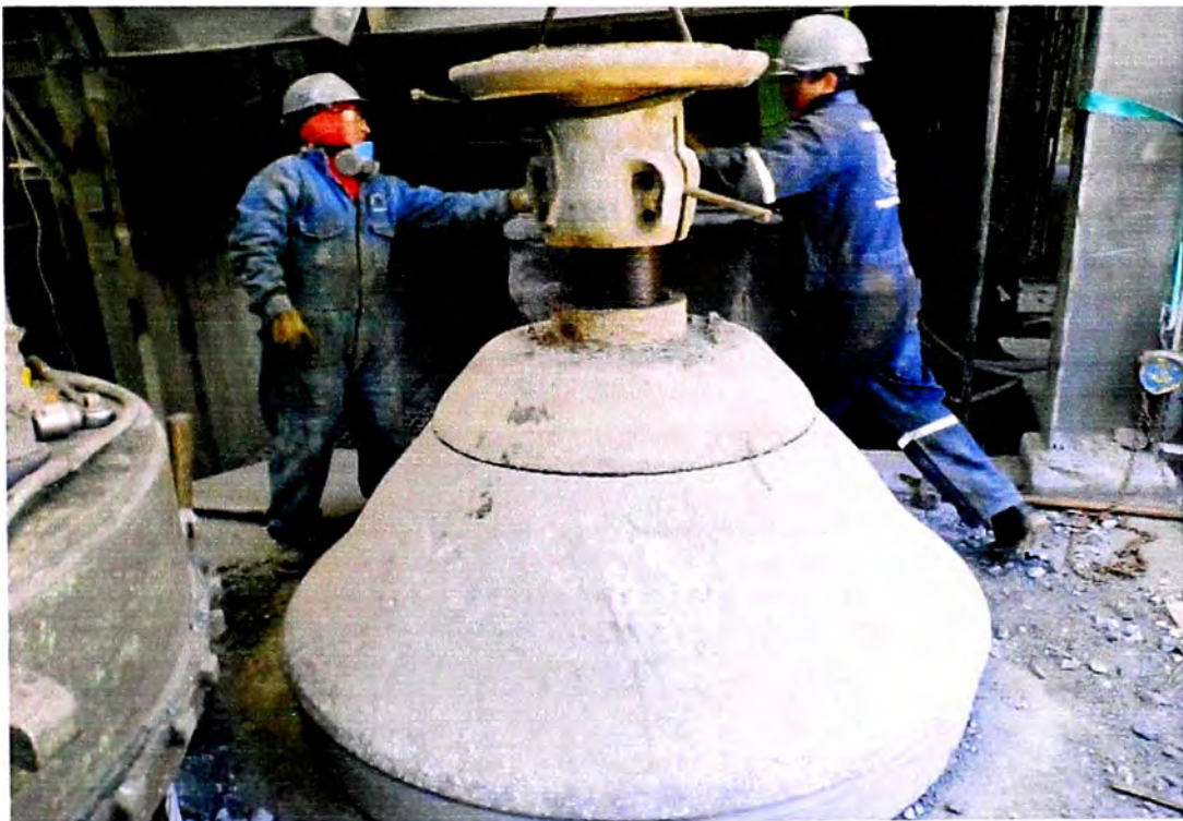
Fig. 4.4: Desmontaje del manto
