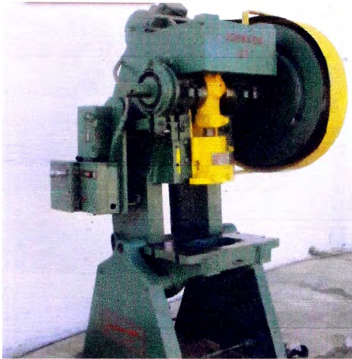
Figura 3.5 Prensa excéntrica JOHNSON 30 T.
