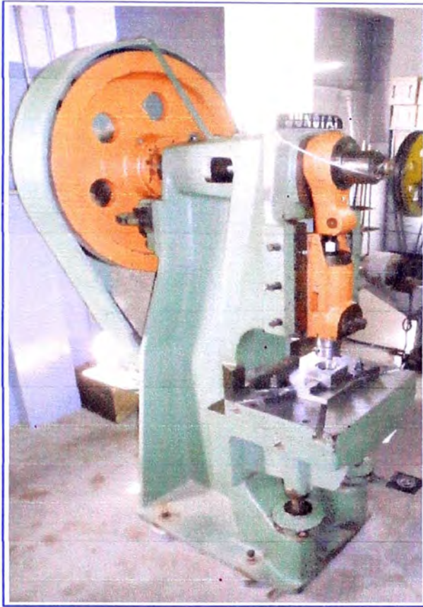
Figura 3.3 Prensa excéntrica JUNDIAI 25 T.
