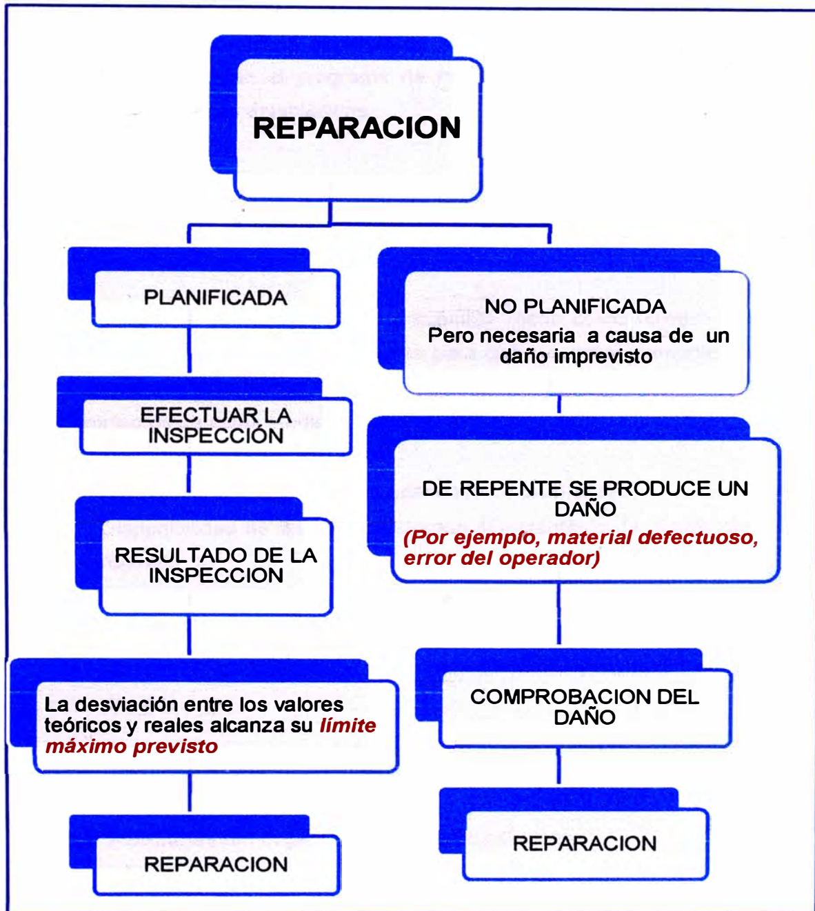
Figura 4.2 Tipos de reparación.
