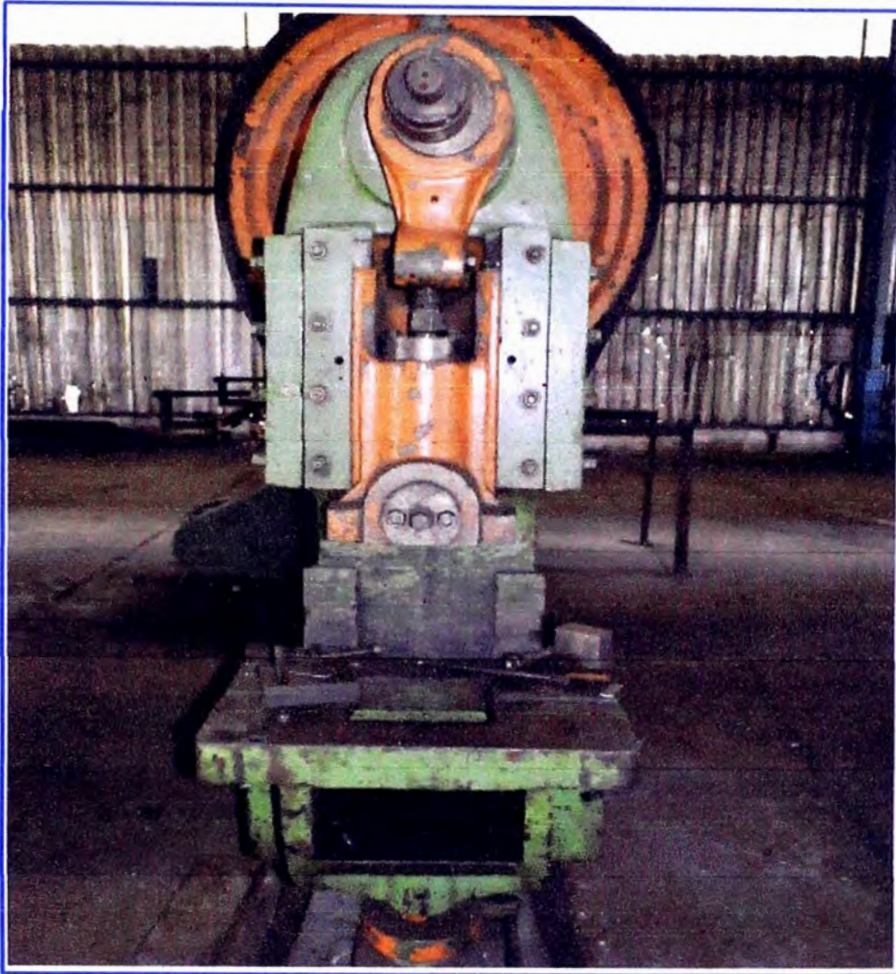
Figura 3.7 Prensa excéntrica RICETTI 45 T.
