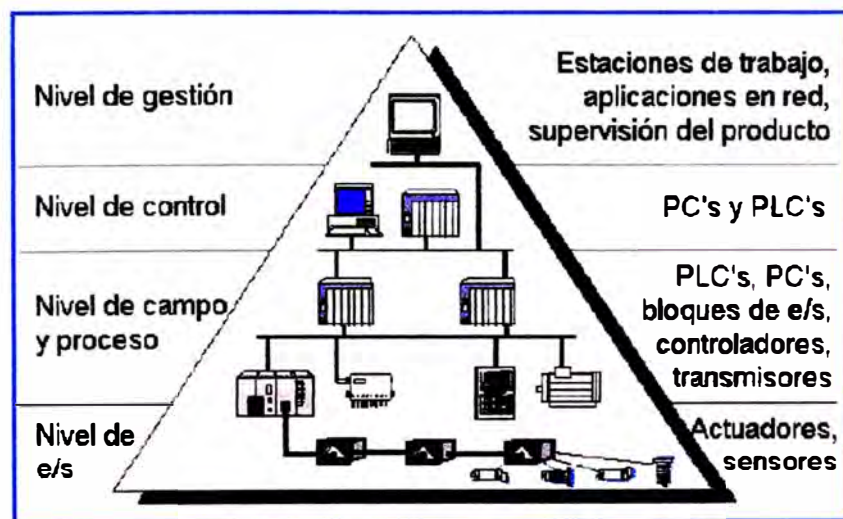
Figura 2.6. Pirámide de automatización
