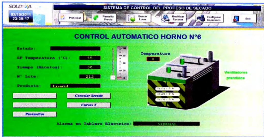
Figura 4.21. Pantalla de cada horno del nuevo SCADA
