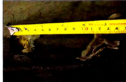
La foto muestra un corte pasante y longitudinal de 13.2 cm aproximadamente (criticidad 2)
