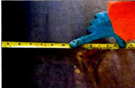
La foto muestra un corte pasante y transversal de 10 cm aproximadamente (criticidad 1)
