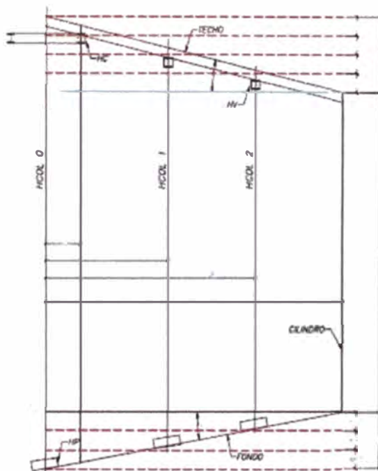
Figura 5.1: Arreglo de columnas y techo cónico
