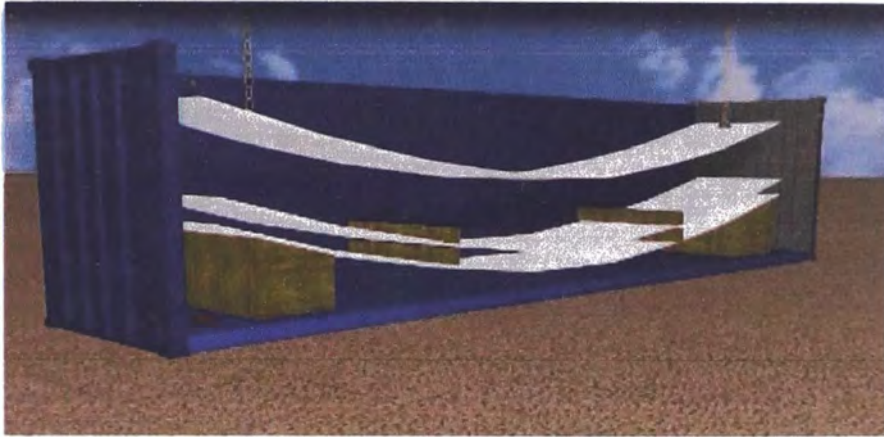
Figura 2.6: Embalado de planchas roladas para envío a obra
