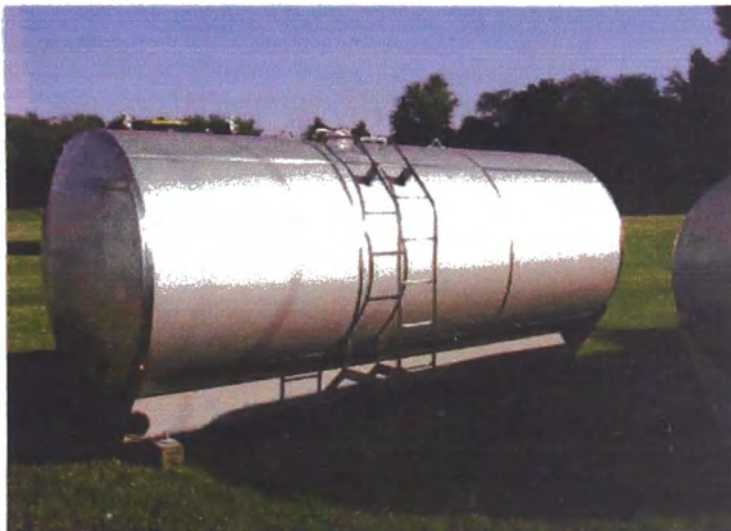
Figura 2.3: Tanque de aluminio para transporte de combustible
