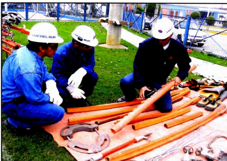
Ilustración 5.12. Inspección de los equipos de protección aislante
