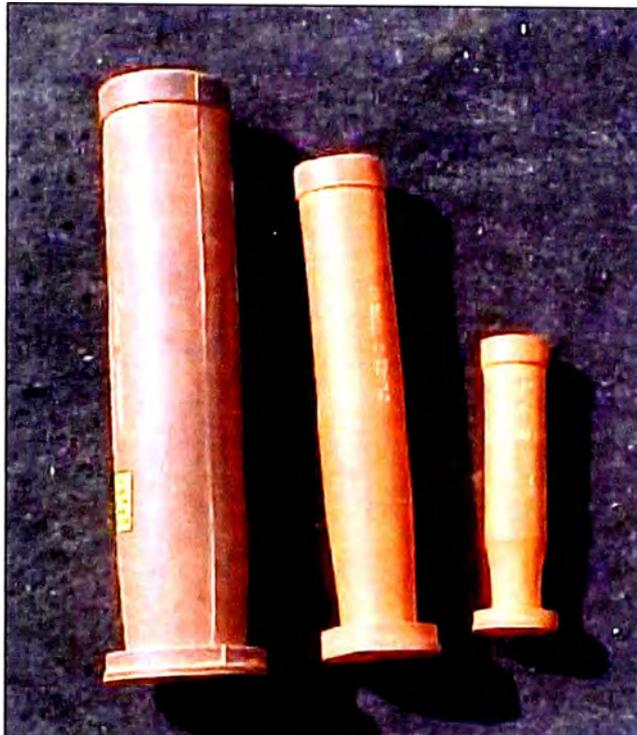
Ilustración 5.11. Protectores de punta de cable. Clase 2
