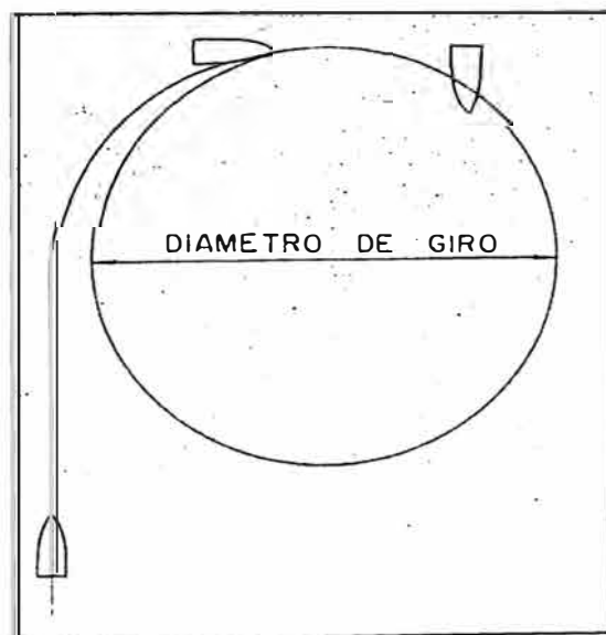
Figura 3.101: Esquema de la prueba de maniobrabilidad (diámetro de giro).
