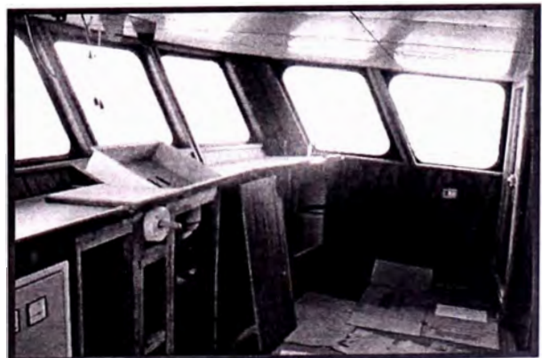
Figura 3.62: Vista de la consola de mando para equipos electrónicos y tableros eléctricos.
