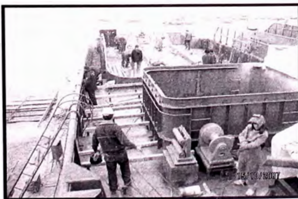
Figura 3.68: Vista de la cubierta principal en la colocación del enjaretado.
