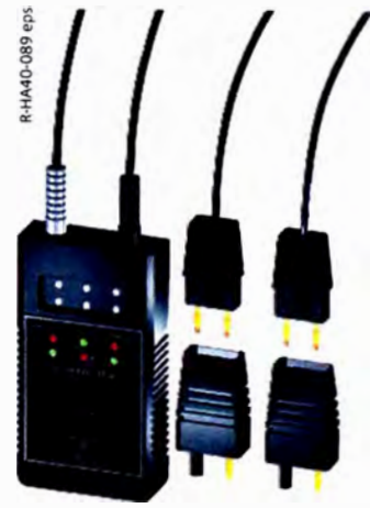
Comparador de fases marca Horstmann, tipo ORION 3.0 como equipo de ensayo combinado para: – Comparación de fases – Comprobación de interfaces en las celdas – Detección de tensión para sistema LRM – Ensayo interno integrado – Indicación a través de LED y alarma acústica
