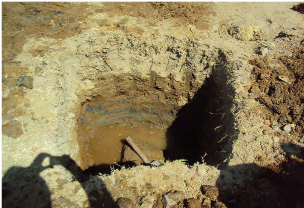
**Foto N°25:** Calicata N°3 de dimensiones 1.40 x 1.0m<sup>2</sup> y profundidad de 1.0m areno arcilloso de color beige se observa el nivel freático, ubicado en el cauce del río.
