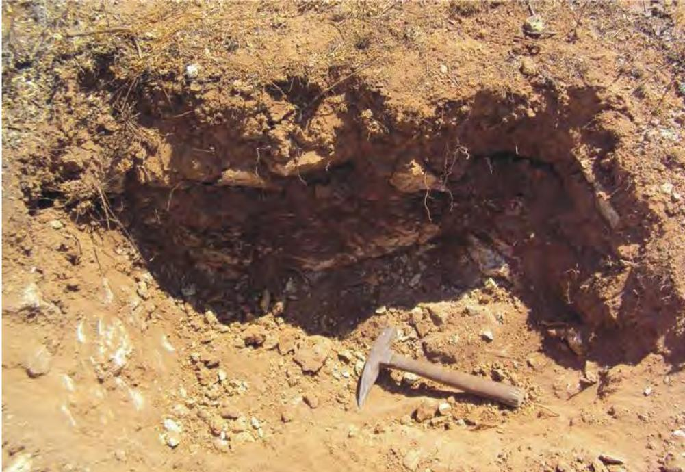
**Foto N°19:** Calicata N°3 de dimensiones 1.10 x 0.65m<sup>2</sup> y profundidad de 0.46m constituido por arcilla arenosa, con clasto angulosos de color beige, ubicado en el estribo derecho.
