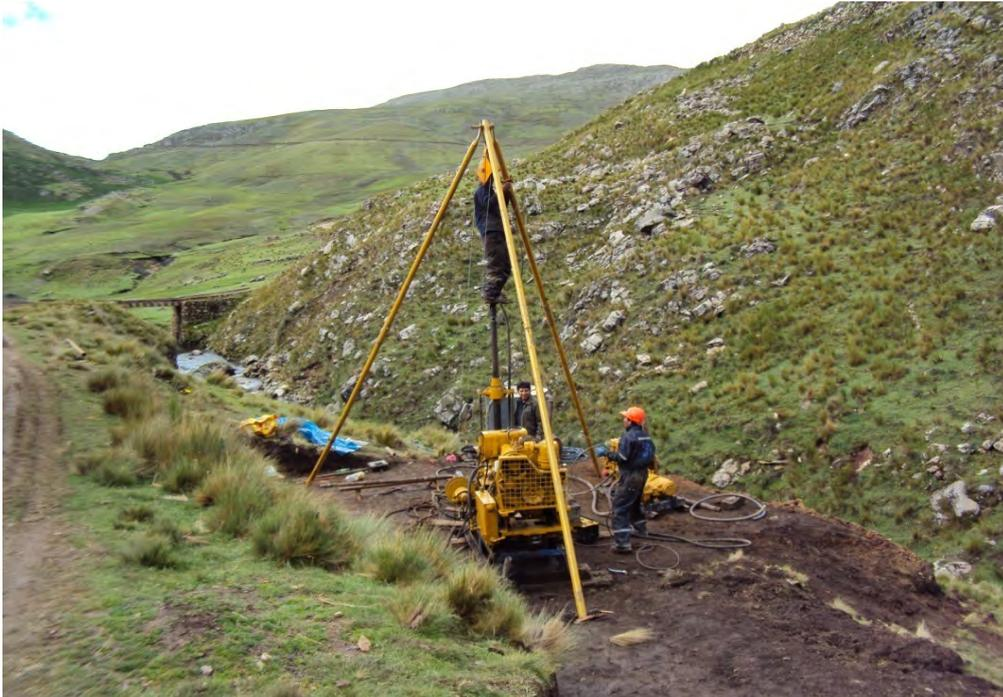
**Foto N°15:** vista hacia el NE, maquina DD200, realizando pruebas o ensayos de permeabilidad en el estribo derecho del eje dique o cortina de la presa.
