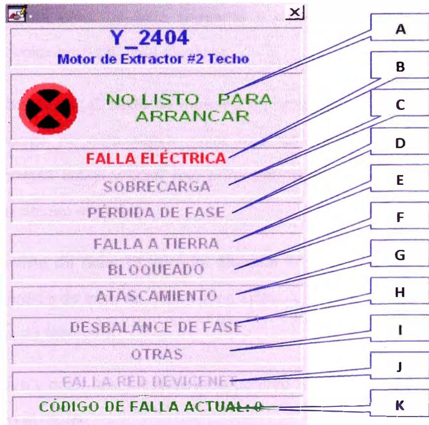
Figura 4.21: Faceplate detallado de motor con falla eléctrica
