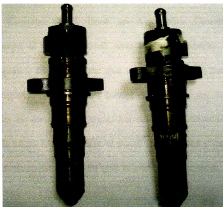
Fig. 2.19. Falla en inyectores de combustible.
