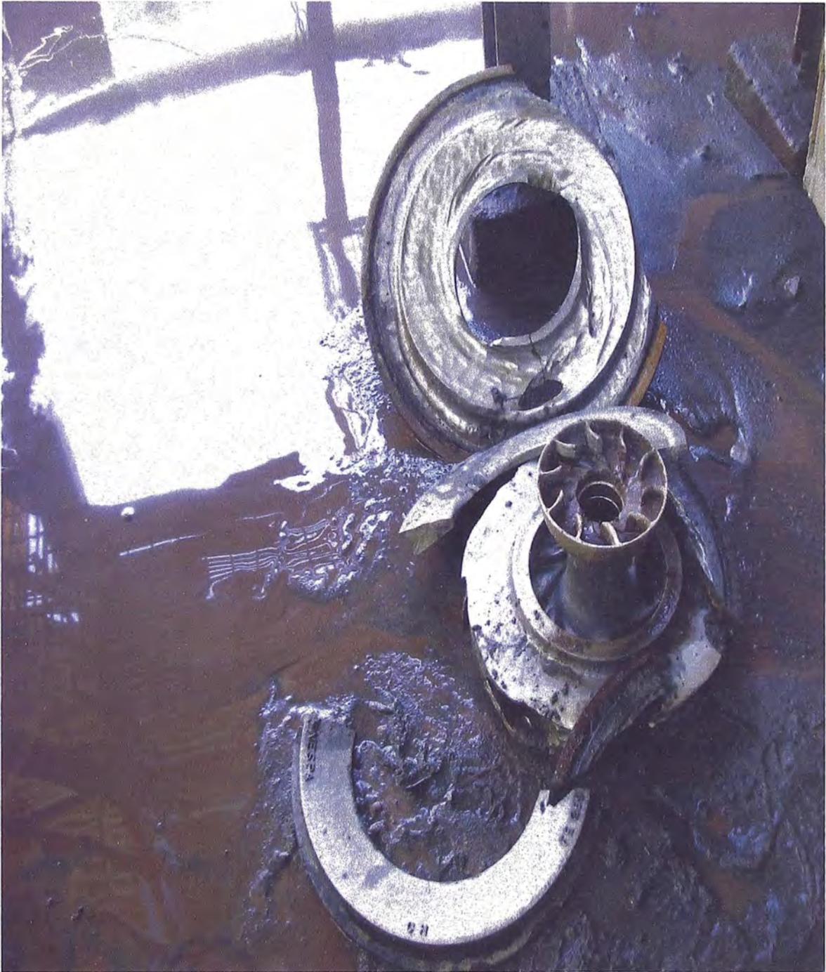
**Fig.3.2** Desgaste prematuro de impulsor, plato seguidor anillado Bomba Wilfley 4k.
