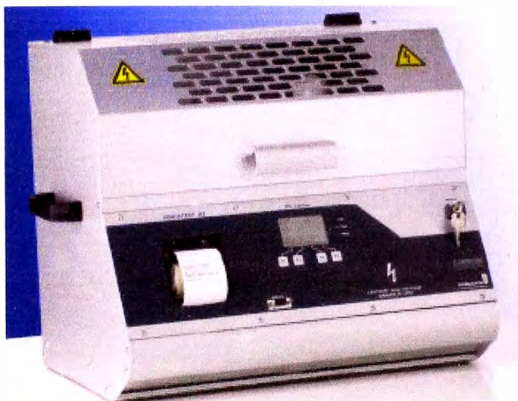
Medidor de rigidez dieléctrica para determinar la tensión de ruptura del líquido aislante
