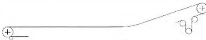
Figura 2.3. Recorrido horizontal y ascendente, cuando el espacio permita la curva vertical y el esfuerzo de la faja lo permita.
