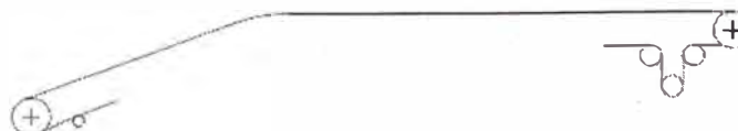
Figura 2.4. Recorrido ascendente y horizontal, cuando el espacio permita la curva vertical y el esfuerzo de la faja lo permita.
