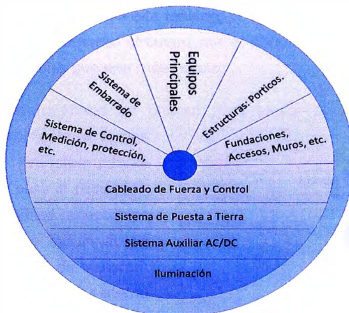
Figura 2.3-1: Componentes Multidisciplinarios de una Subestación
