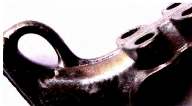
Fig. 4.2 Llenado incompleto de la pieza originada por una velocidad de colada menor a la requerida o por una temperatura de fusión baja en la colada (frío).
