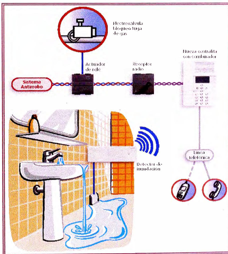
FIG. 3.14: DETECCIÓN DE INUNDACION
