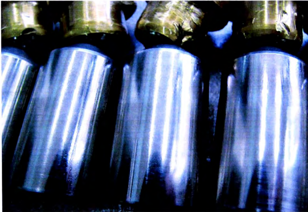
Figura N° 4. 3 Pistones sin presencia de desgaste adhesivo.
