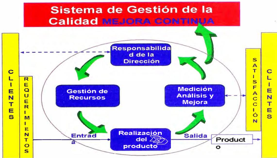
**Fig. 2.4 Modelo de la Norma ISO 9001:2000 de un sistema de gestión de la calidad basado en procesos**
