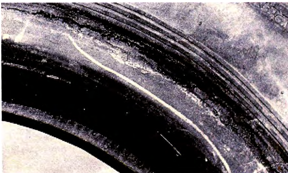
Fig. 4.14 Falla por la pestaña
