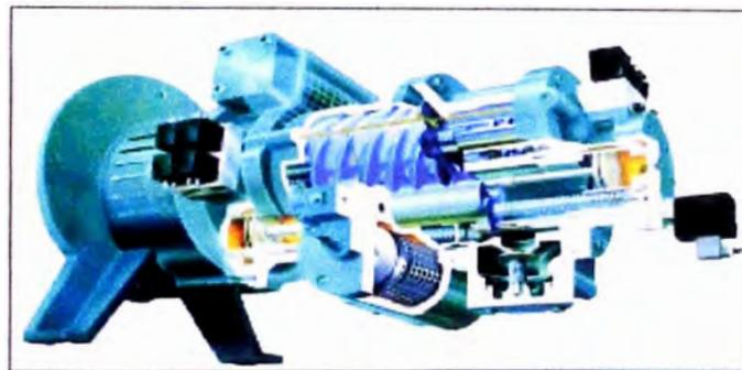
Figura 3.4 Compresor de tornillo
