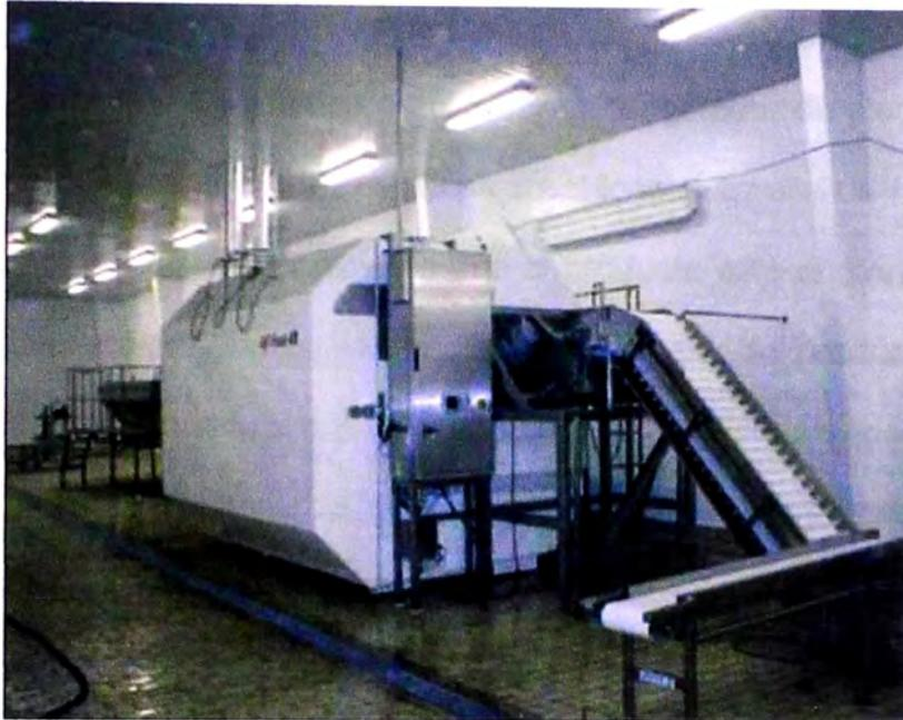
Fig. 3.10 Túnel de congelamiento continuo
