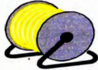
Desenrolle el cable en un soporte
