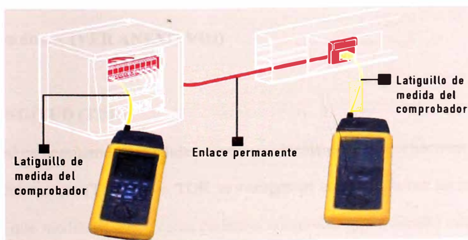
Fig. 4.1 Prueba de enlace permanente
