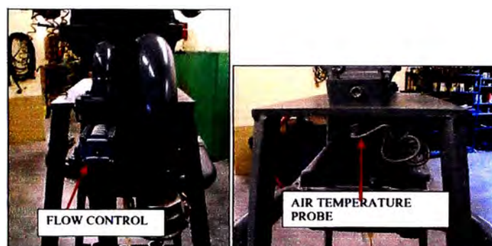
FIGURA 4.1 Vistas del equipo posenfriador que usa este distribuidor
