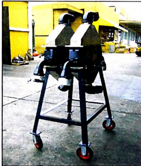
FIGURA 3.11 Vista del equipo posenfriador de aire usado por el distribuidor Gecolsa para pruebas de motores Caterpillar, en esta imagen se indica las líneas de succión y descarga de aire y agua, así como se observa que los centros intercambiadores de calor están en paralelo o en serie dependiendo de las conexiones de las líneas.
