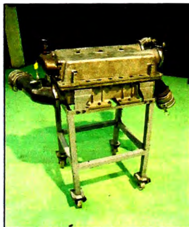
FIGURA 3.3 Vista del equipo posenfriador usado actualmente en el CRC para las pruebas de motor C32 Caterpillar.
