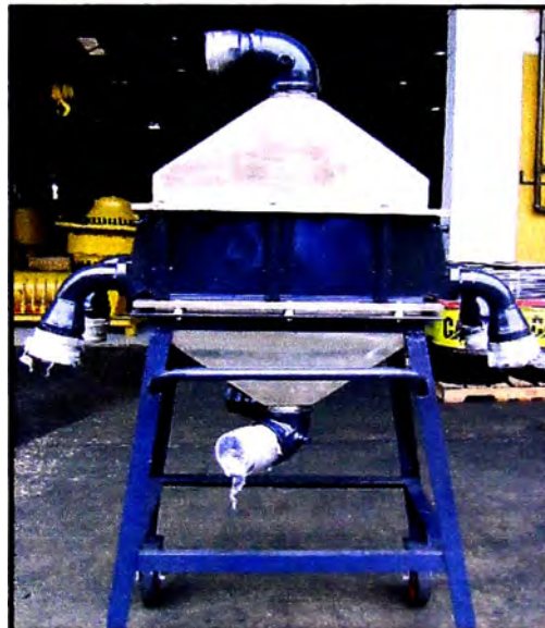
FIGURA 3.12 Vista lateral del equipo posenfriador de aire usado por el distribuidor Gecolsa para pruebas de motores Caterpillar, en esta imagen se puede apreciar las tomas de aire y agua para las líneas que se deban instalar.
