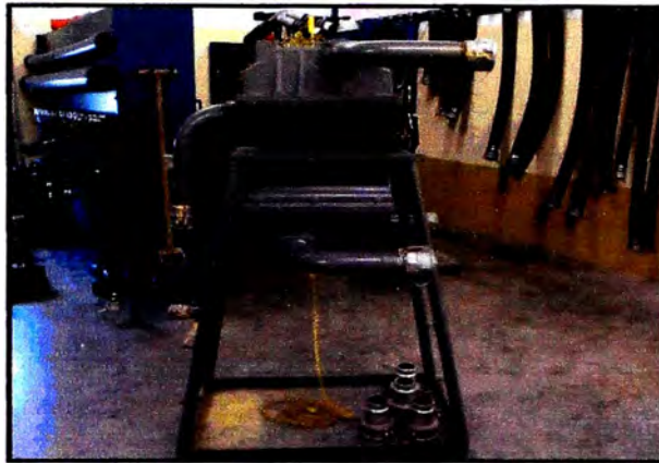
FIGURA 3.10 Vista lateral del equipo posenfriador de aire usado por el distribuidor WM para pruebas de motores Caterpillar, en esta imagen se indica las líneas de succión y descarga de aire y agua.
