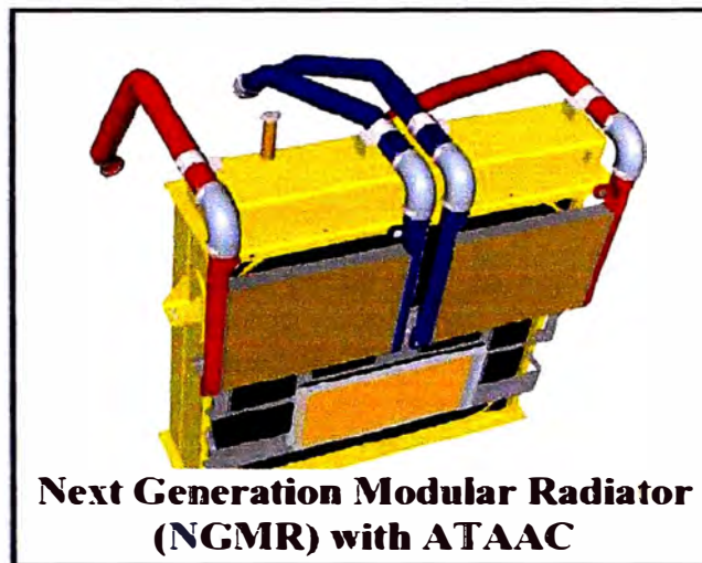
FIGURA 1.3 Vista del posenfriador de aire original del motor del camión 777F de Caterpillar.
