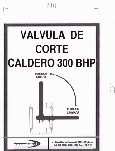
Figura 17: Rótulo para válvulas de corte de equipos
