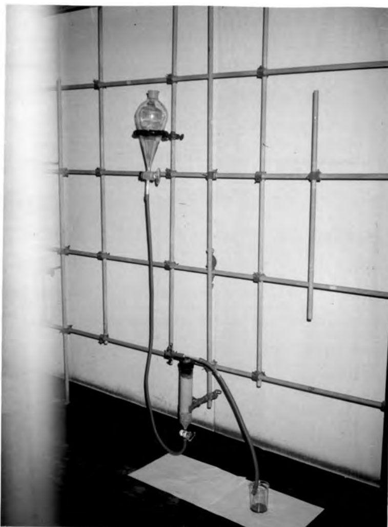
FIG. 5.4. INICIO DE LA REGENERACION CON NaOH
