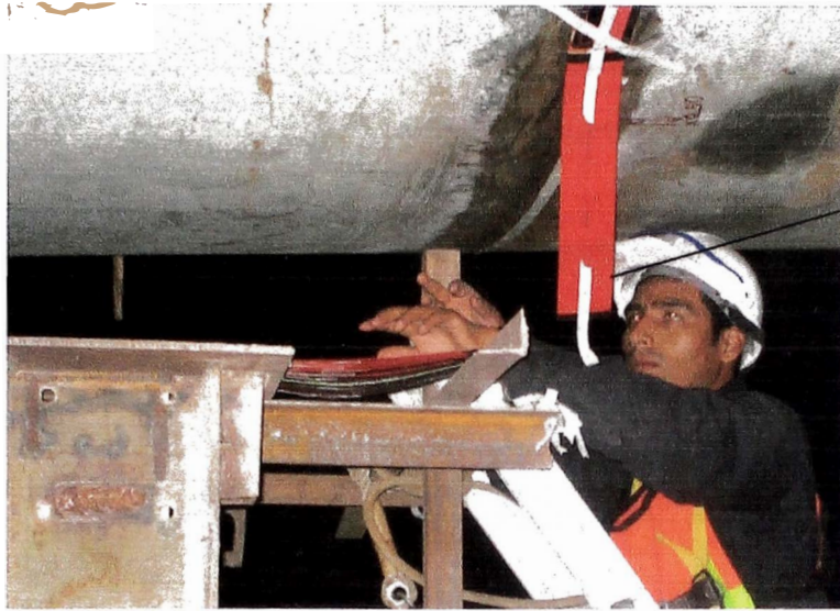
Despegue de Placas luego del Disparo de rayos gamma
