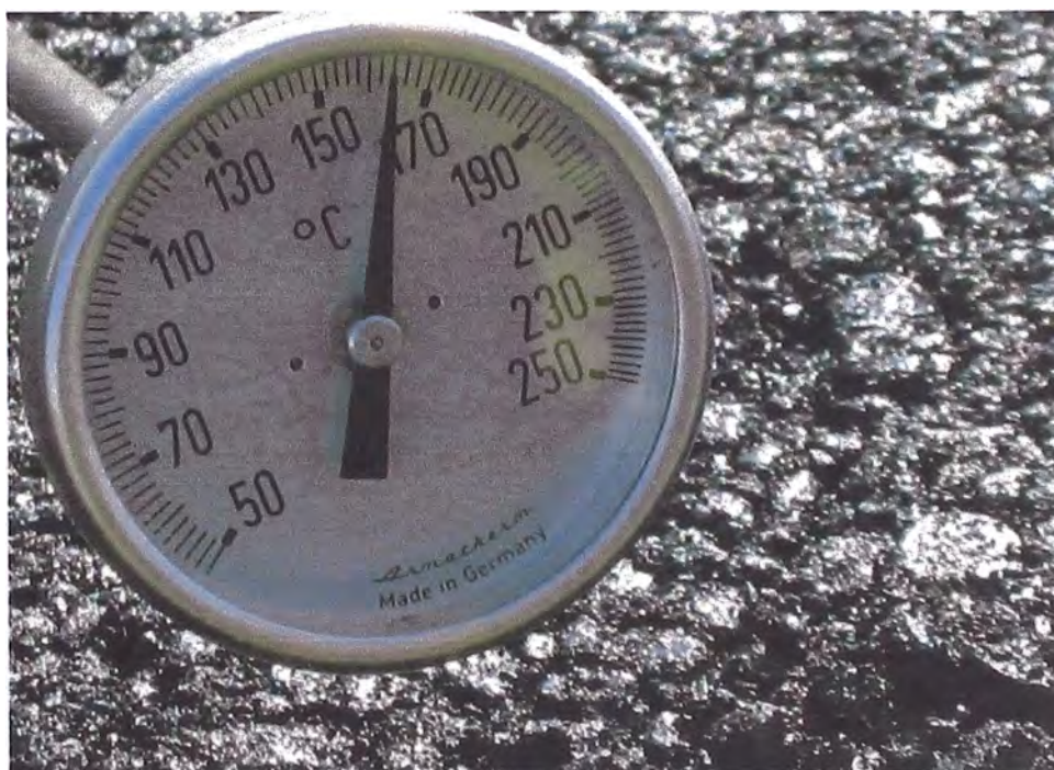
Figura N°18 Control de temperatura de inicio de proceso de rodillado (rodillo Tamden).
