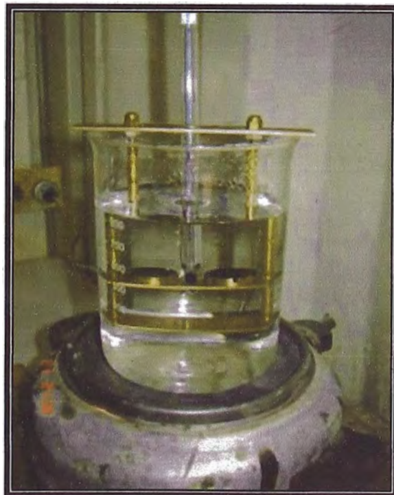
Foto 06: Aparato anillo y esfera usado en obra Fuente: Elaboración propia
