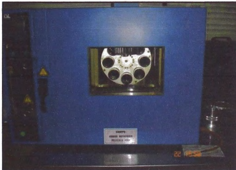
Foto 29: Horno para ensayo de película delgada rotativa (RTFO) Fuente: Elaboración propia
