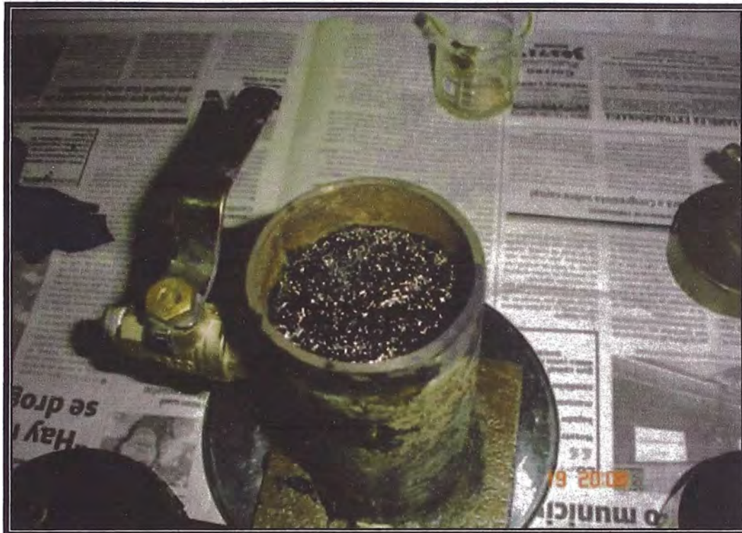
Foto 17: Vista de la separación polímero-asfalto base
