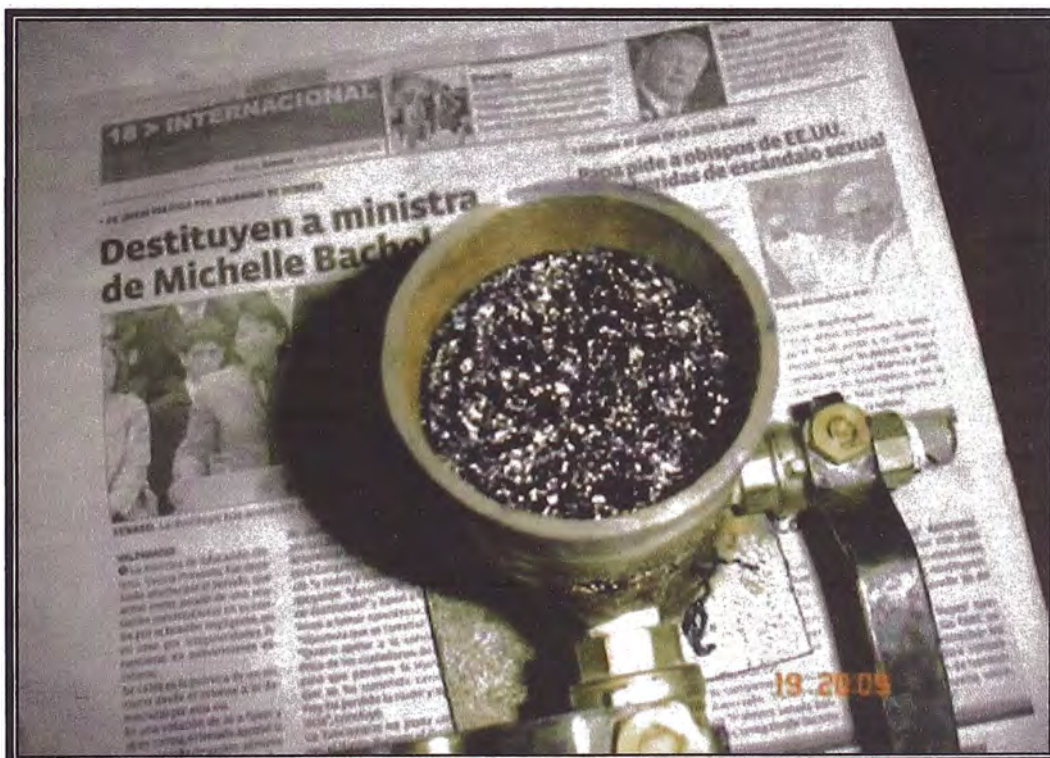
Foto 18: Vista de la separación polímero-asfalto base planta
