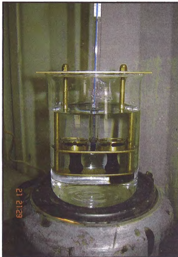
Foto 22: Ensayo de penetración en asfalto modificado Fuente: Elaboración propia
