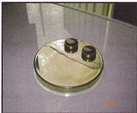
Foto 22: Ensayo de penetración en asfalto modificado Fuente: Elaboración propia
