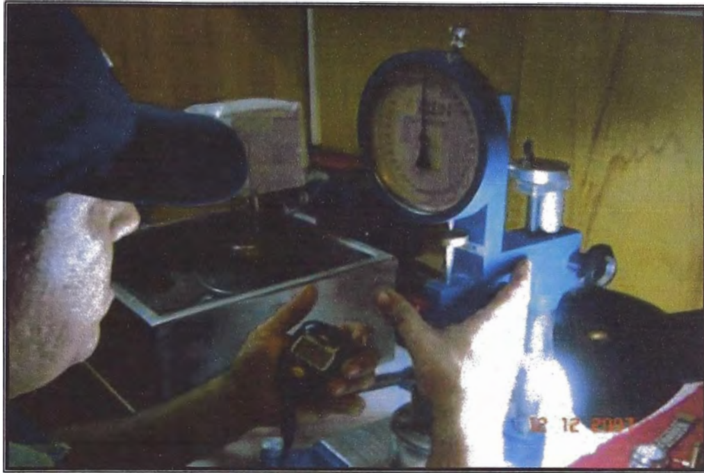
Foto 22: Ensayo de penetración en asfalto modificado Fuente: Elaboración propia
