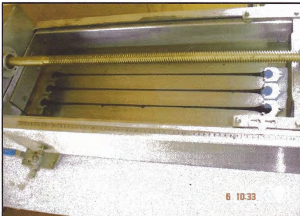
Foto 27: Final ensayo de ductilidad en muestras de asfalto modificado En un tina de acero inoxidable a 5°C según norma MTC E 306 Fuente: Elaboración propia
