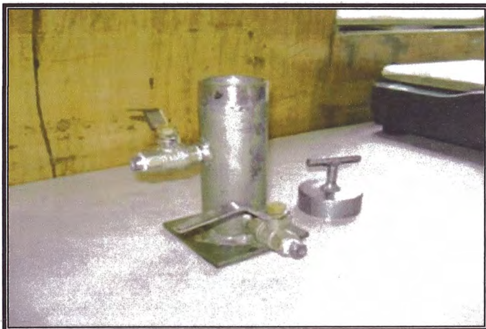
Foto 12: Recipiente para el ensayo de estabilidad al almacenamiento Fuente: Elaboración propia
