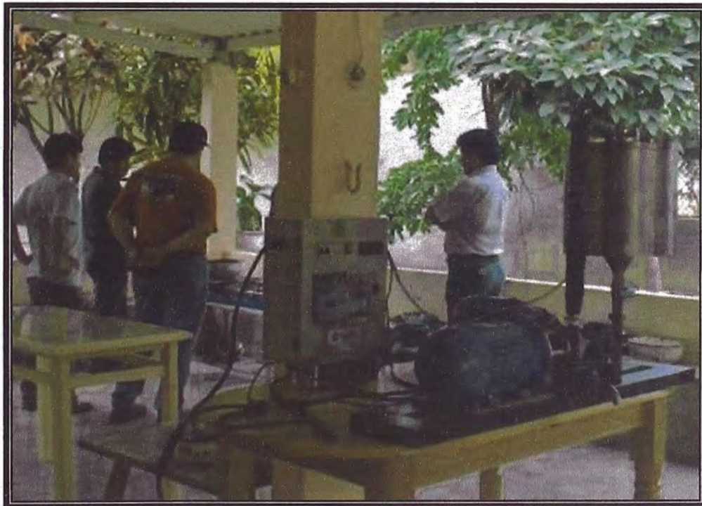
Foto 02: Instalación del molino coloidal Fuente: Elaboración propia
