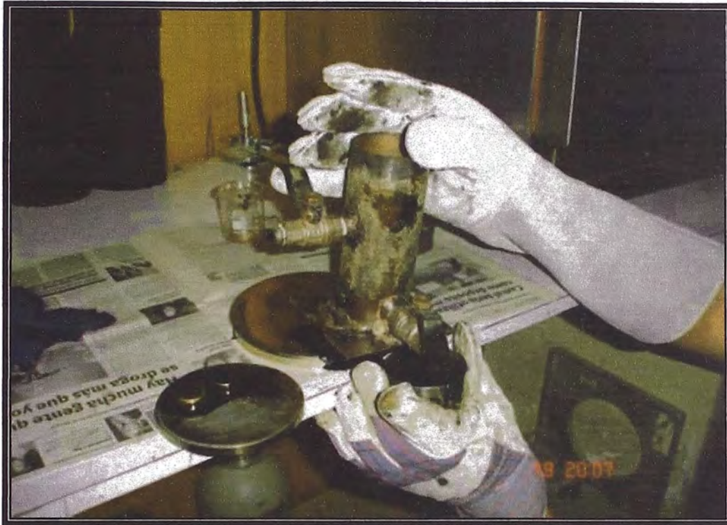
Foto 15: Toma de muestras de la parte Inferior del recipiente Para estabilidad al almacenamiento-vista frontal Fuente: Elaboración propia
