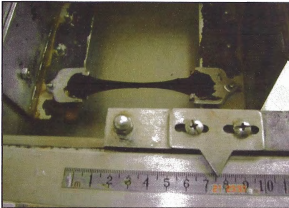
Foto 26: Inicio ensayo de ductilidad en muestras de asfalto modificado En un tina de acero inoxidable a 5°C según norma MTC E 306 Fuente: Elaboración propia
