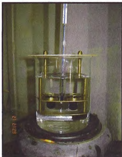
Foto 23: Ensayo de anillo y bola en asfalto modificado Fuente: Elaboración propia
