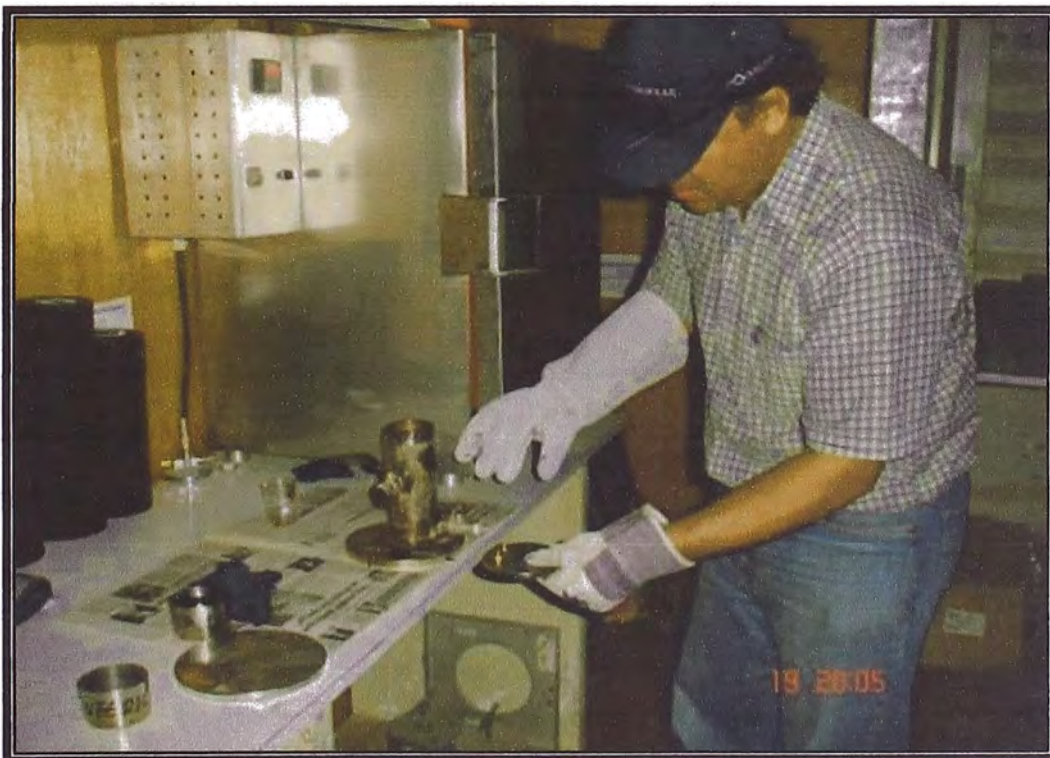
Foto 16: Toma de muestras de la parte Inferior del recipiente Para estabilidad al almacenamiento-vista lat. Fuente: Elaboración propia
