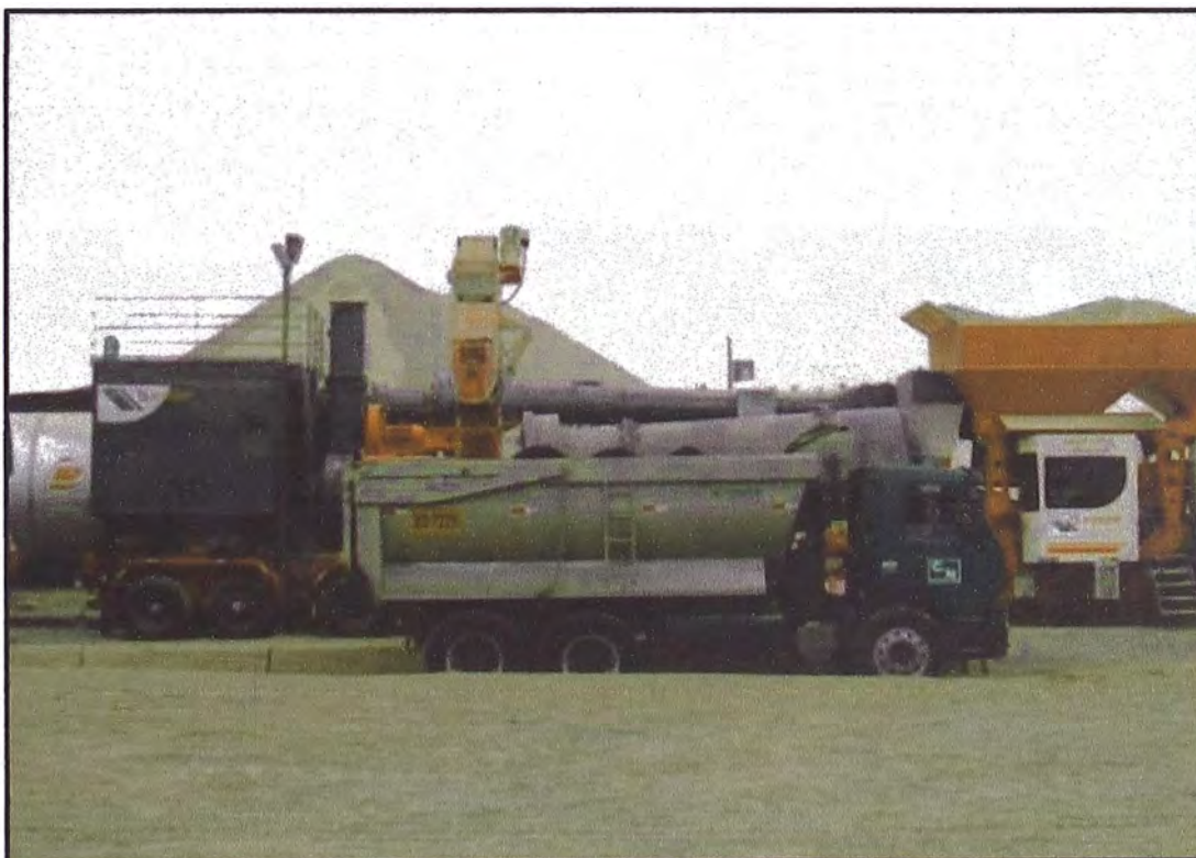
Foto 33: Vista frontal de la planta de asfalto en carguío de volquete Fuente: Elaboración propia
