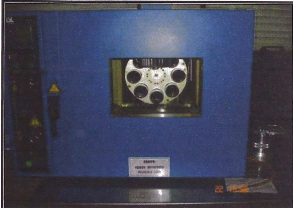
Foto 11: Horno para ensayo de película delgada rotativa (RTFO) – Laboratorio de Petroperú Talara
