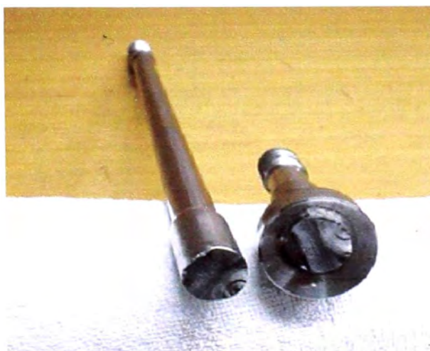
ROTURA DE PERNO LATERAL
