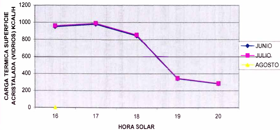
GRÁFICO N° 3 DIAGRAMA DE CARGA TERMICA REAL EN LA SUPERFICIE ACRISTALADA (VIDRIOS) JUNIO, JULIO Y AGOSTO
