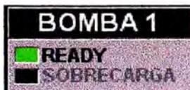
Este recuadro lanza la pantalla de control de bomba, pero adicionalmente a esto podemos observar el estado de la bomba y una alarma por sobrecarga.
