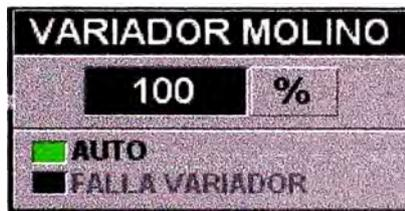
Indicador del % de salida del variador de velocidad, este porcentaje es referente a la frecuencia del mismo, presenta indicadores de tipo de control “Manual” y “Automático”, además una alarma de falla en el variador.
