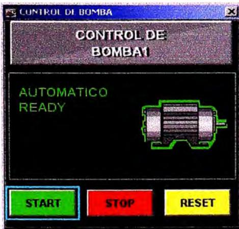
Esta pantalla no permite realizar los comandos de arranque “START”, parada “STOP” y reseteo de falla “RESET”, también nos muestra una indicación del status de la bomba, si es verde la bomba esta arrancada, si esta de rojo la bomba esta parada.
