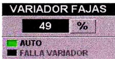
En esta parte del sistema de supervisión podemos apreciar el porcentaje de salida del variador de velocidad, además existe un led y un texto, cuando el variador esta en modo automático el texto cambia a **AUTO** y el led se pone de color verde, cuando el variador esta en manual, el texto cambia a **MANUAL** y el led a rojo. También esta parte de la pantalla nos
