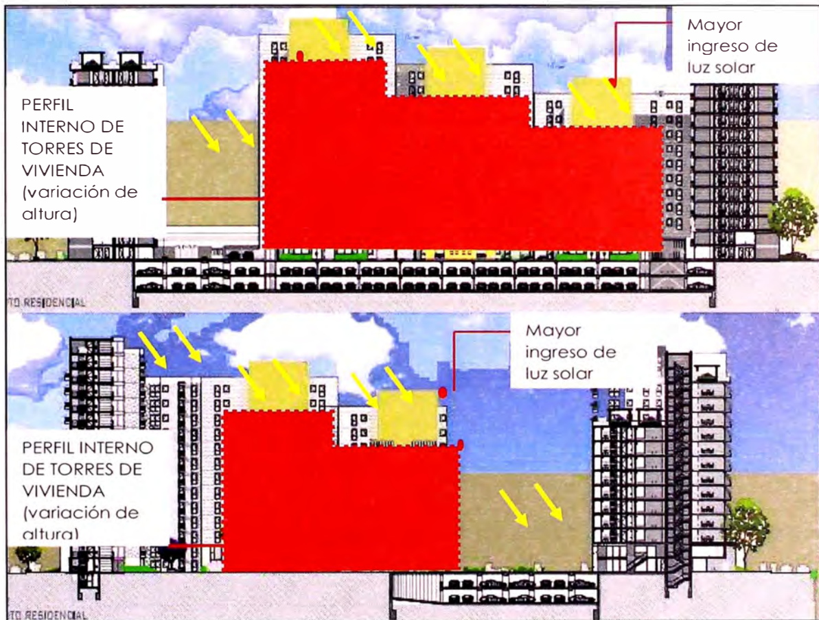
Imagen N°40: Corte esquemático respecto a la iluminación natural interior.
