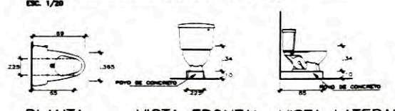
PLANTA VISTA FRONTAL VISTA LATERAL
