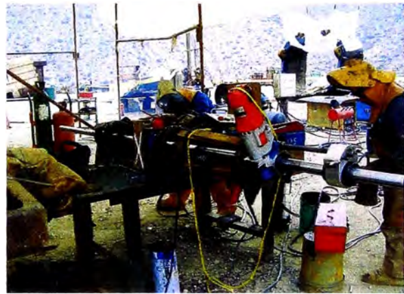
Fig. 7.77. Maquinado final de los alojamientos
