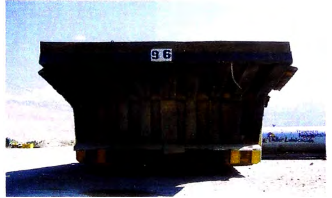
Fig.7.2 Canales de Canopo deformados, de tolva con plancha base deteriorada
