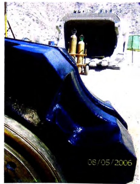
Fig. 7.63 Se debe de tener especial cuidado en la forma curva del inicio de los dientes
