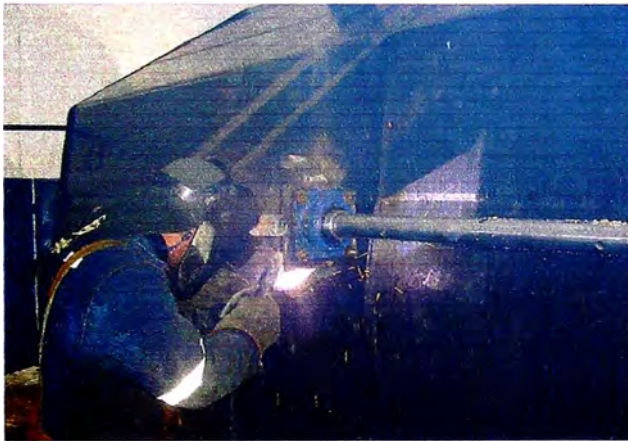
Fig. 7.43 Relleno y rectificado de bocinas:
