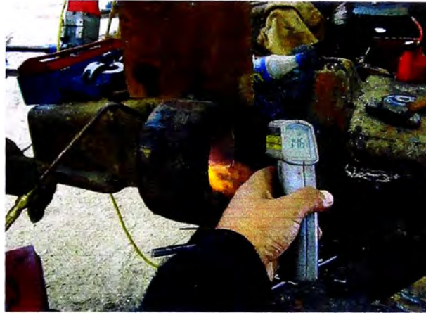
Fig. 7.74. La temperatura de soldeo durante la aplicación del alambre TeroMatec 3205 debe estar entre 170°C a 260°C.
