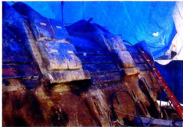
Fig. 7.55, 7.56, 7.57 Kit antidesgaste de la base del cucharón
