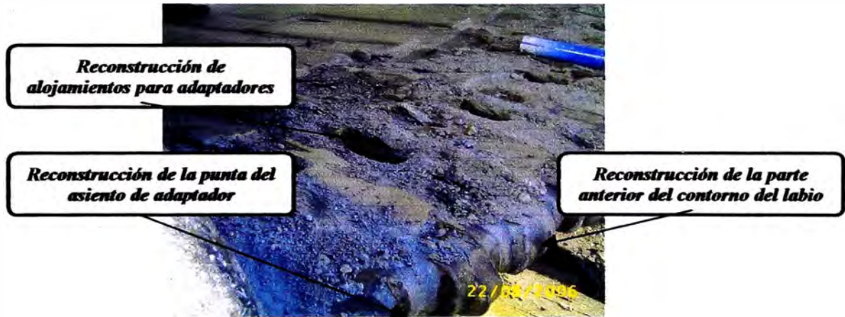
Fig. 7.23 Desgaste severo del labio y seguro de adapter
