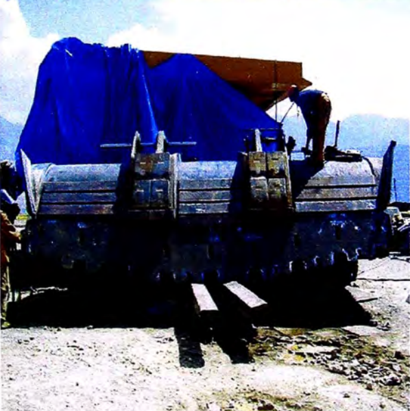
Fig. 7.55, 7.56, 7.57 Kit antidesgaste de la base del cucharón
