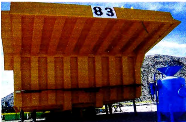
Fig. 7.18 Vista frontal de tolva terminada
