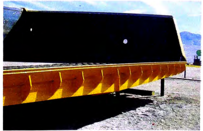
Fig.7.20 Acabado final de la tolva, luego de la reparación
