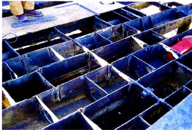
Fig. 7.11 Colocación de cartelas en canales, lado de acción de los pistones de levante de tolva
