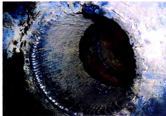
Fig 7.44 Relleno por soldadura:
