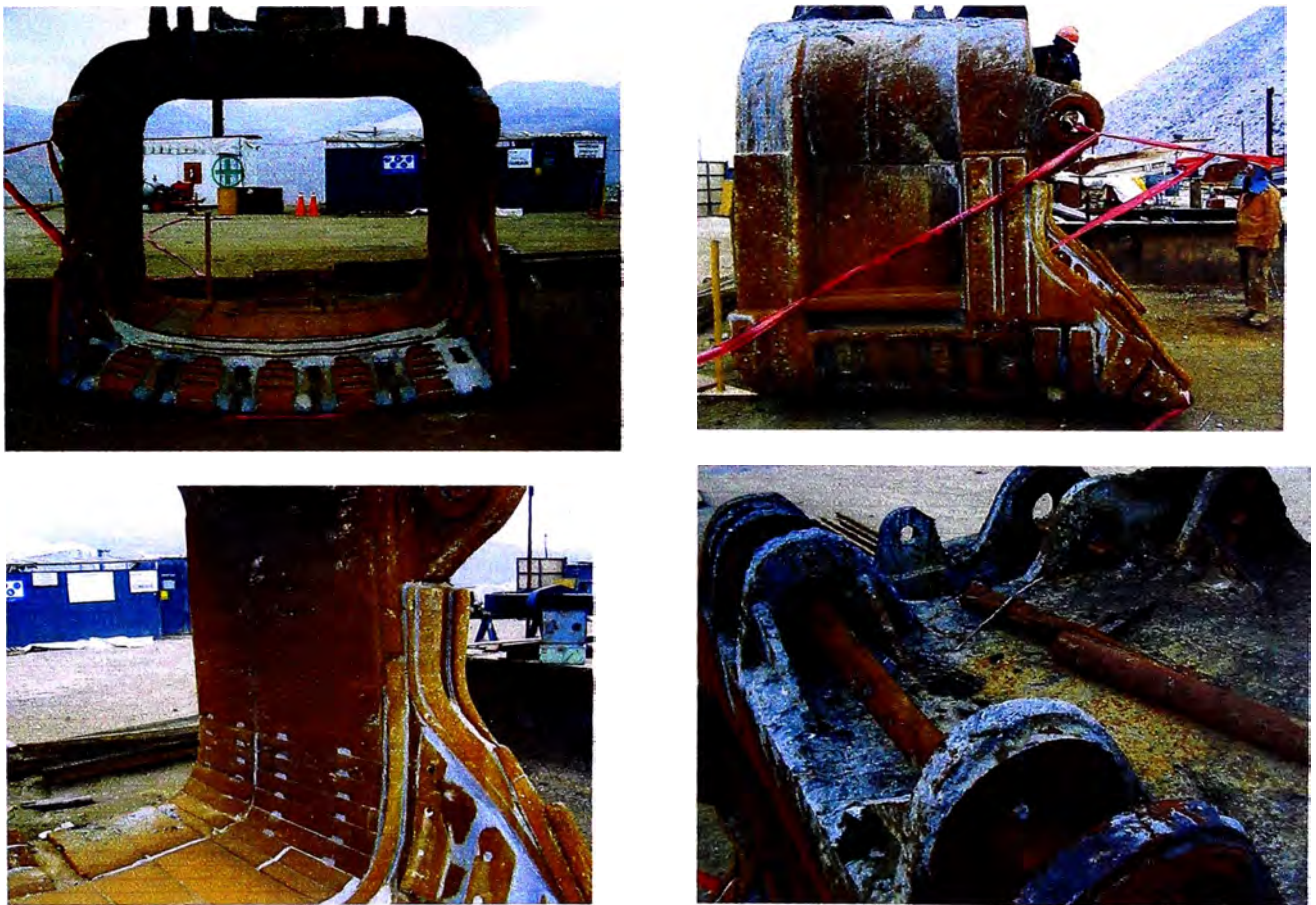
Fig. 7.21 Estado inicial del cucharón antes de la reparación
