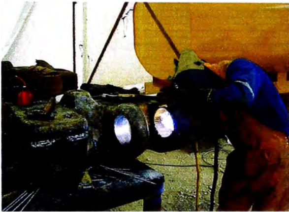
Fig. 7.76 Relleno de alojamientos con FutecTrode 54
