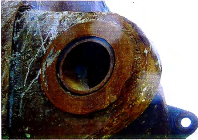
Fig. 7.34 Alojamiento de parte frontal de cucharón (sufré el mayor desgaste)
