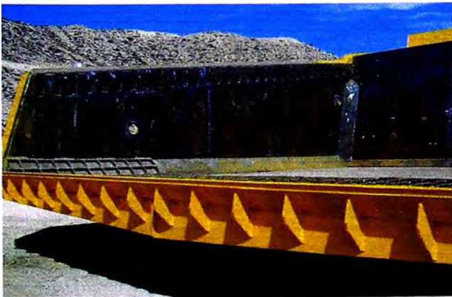
Fig.7.20 Acabado final de la tolva, luego de la reparación
