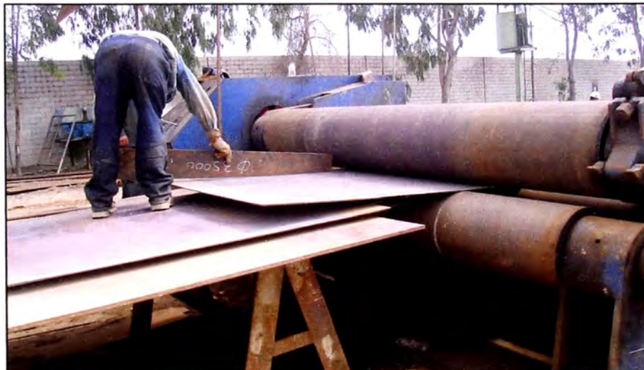
Fig. 3.4 Rolado de planchas.
