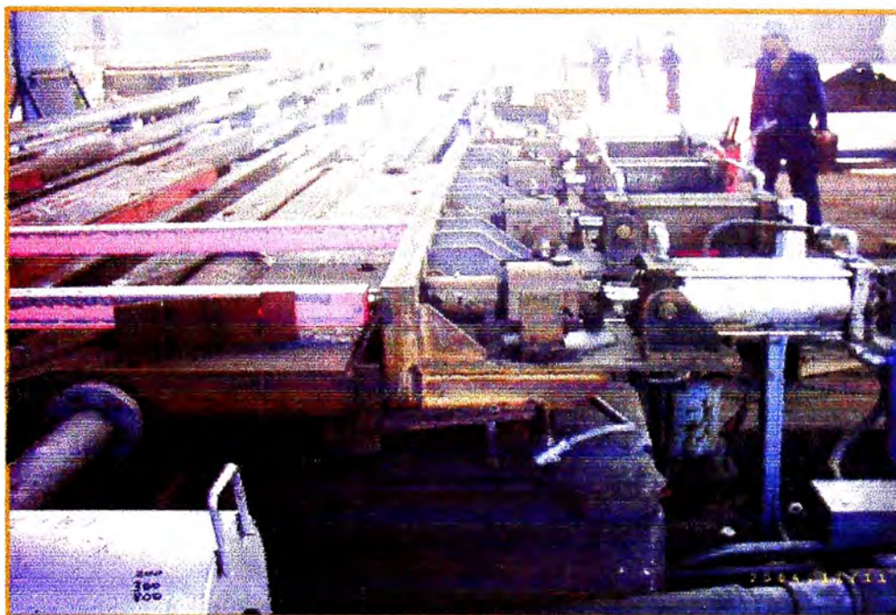
Fig. 4.9 Proceso de evaluación y evacuación de las palanquillas por la mesa de transferencia y mesa de enfriamiento
