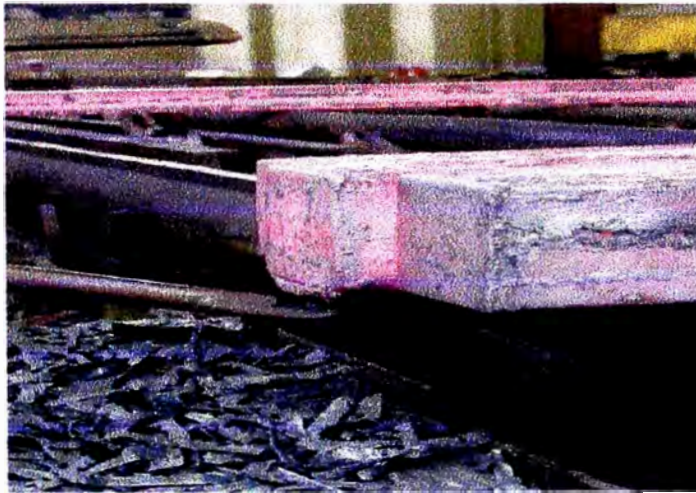
Fig. 6.1 Rebarbado de palanquilla em forma manual
