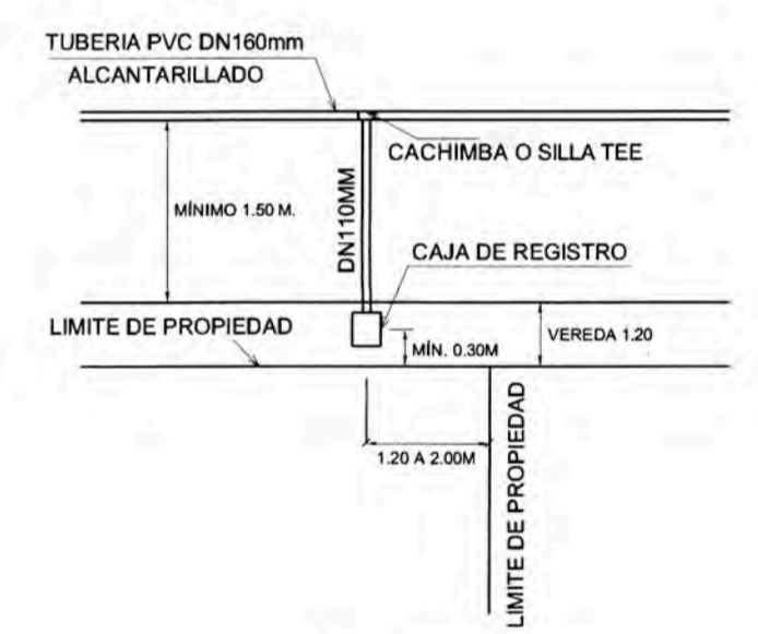
PLANTA CONEXION DOMICILIARIA DE ALCANTARILLADO
