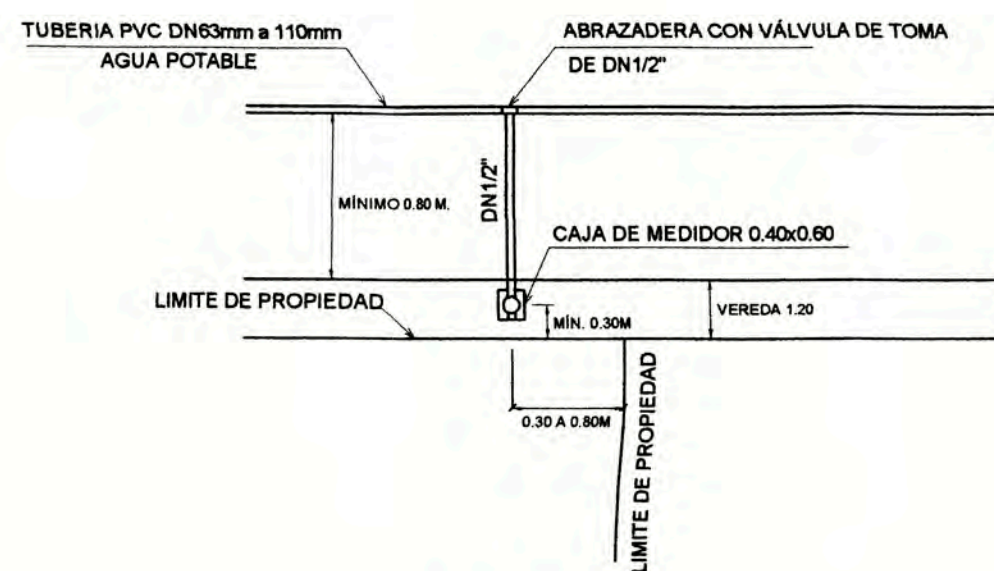
PLANTA CONEXION DOMICILIARIA DE AGUA
