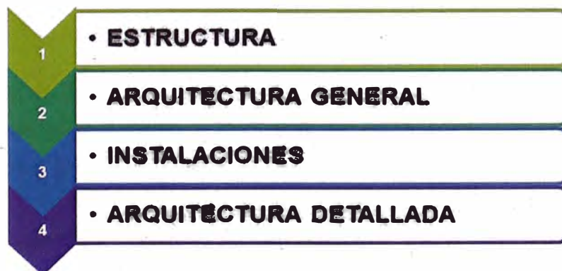
Figura N° 3.3. Secuencia Constructiva para el Modelado de la Información de 2D a 3D
