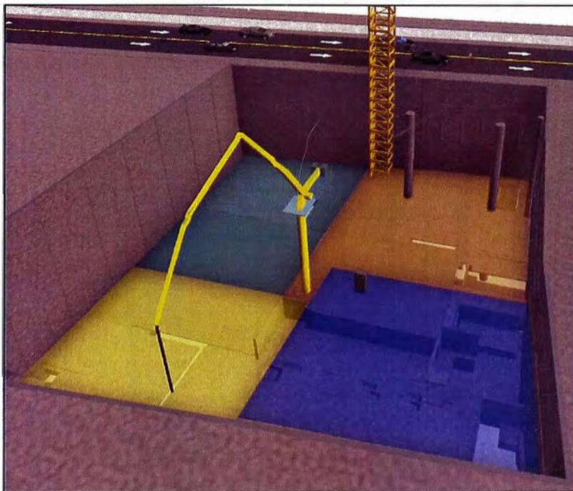
Figura 37: Modelamiento BIM de Sectorización de sótanos
