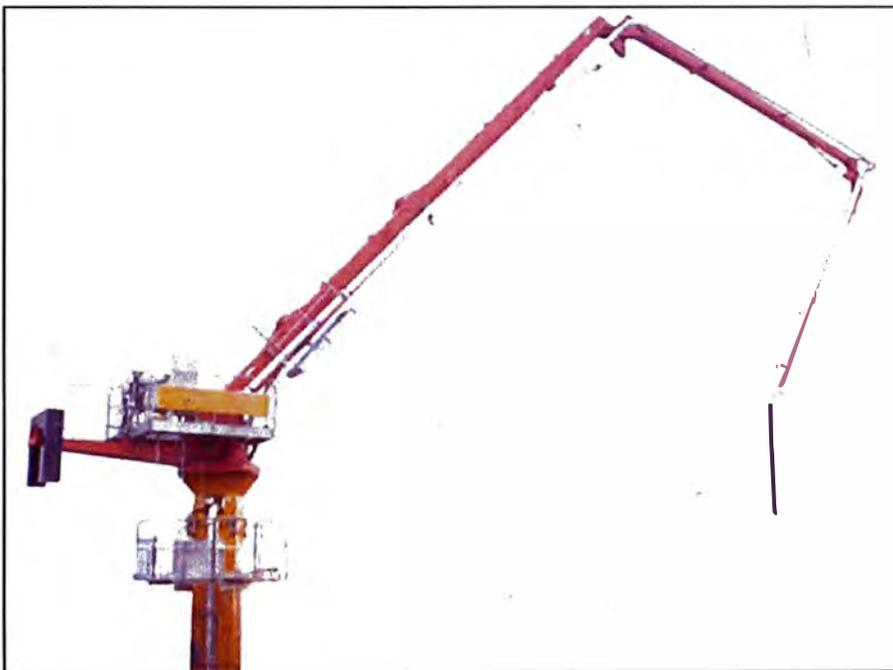
*Figura 12: Pluma distribuidora de concreto premezclado*
