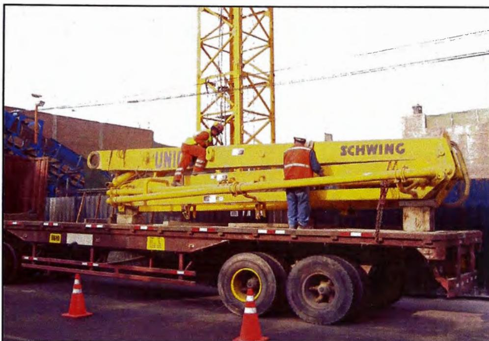
*Figura 51: Traslado de Pluma con camión*
