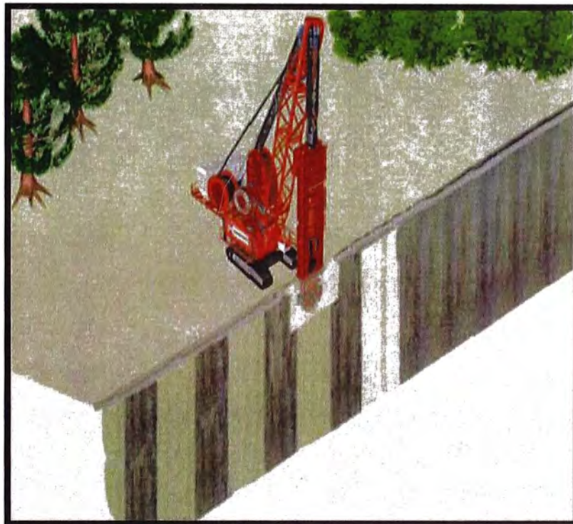
Figura 4.2: Construcción de los módulos intermedios o de cierre.
