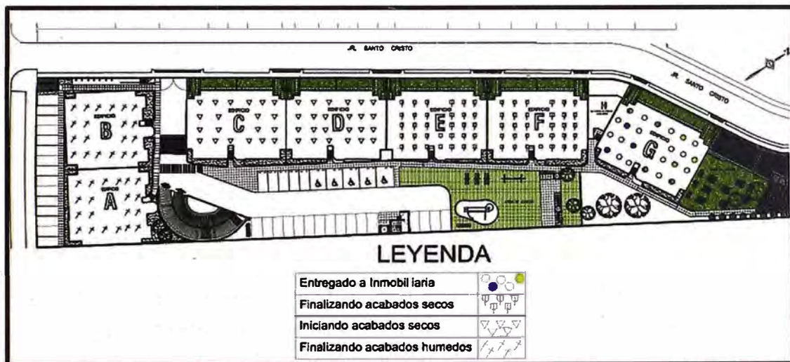
Figura N°2.- Avance constructivo de las torres
