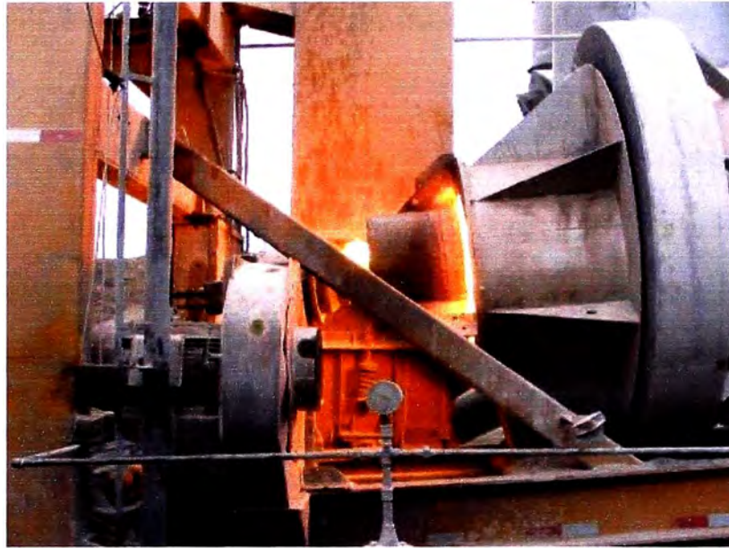
Fig. 2.6.1 Quemador de petróleo industrial
