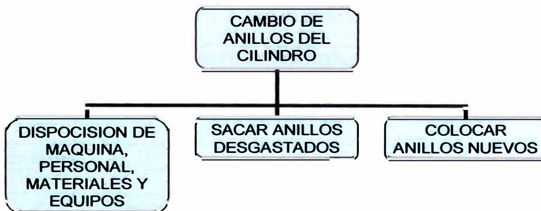
Fig. 5.1.8.1 WBS del Cambio de anillos del cilindro
