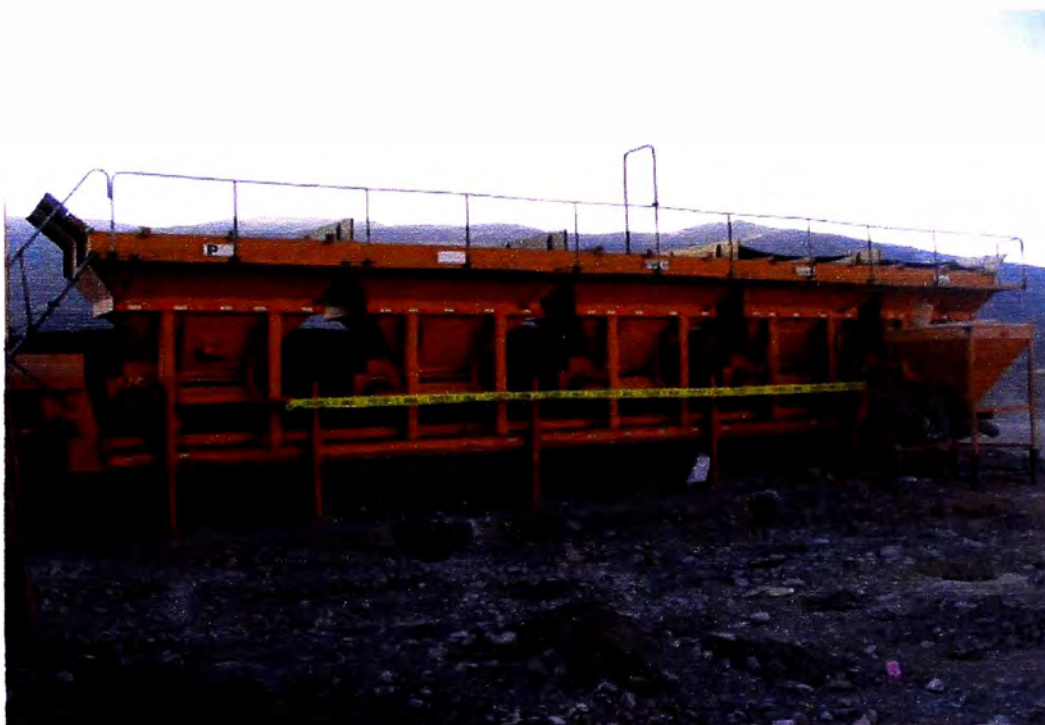
Fig. 2.3.1 Dosificadores de agregados.
