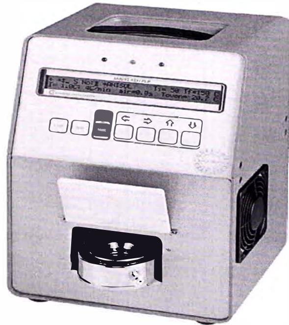
Figura Nº 4.3.1.2.- Equipo para determinar el Flash Point
