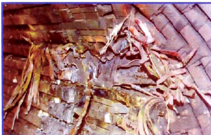
Fig. 4.6.- Falla por operación anormal
