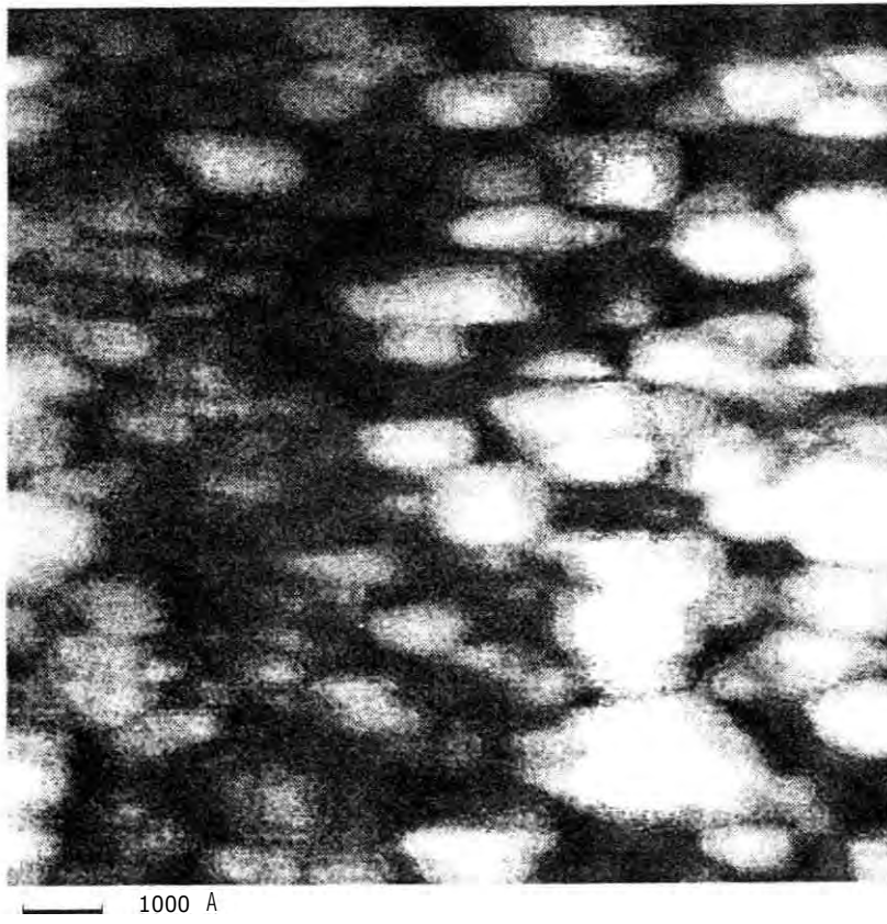
Fig. 3.13. Imagen por AFM de la superficie de ZnO/vidrio obtenida a 420 °C, la forma de los granos es de forma circular con tamaño promedio de 113 nm.
