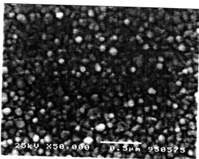
Fig. 3.36 Micrografía SEM de la muestra con 2 % de dopaje, los conglomerado de granos miden desde 110 a 250 nm con promedio de 130 nm.
