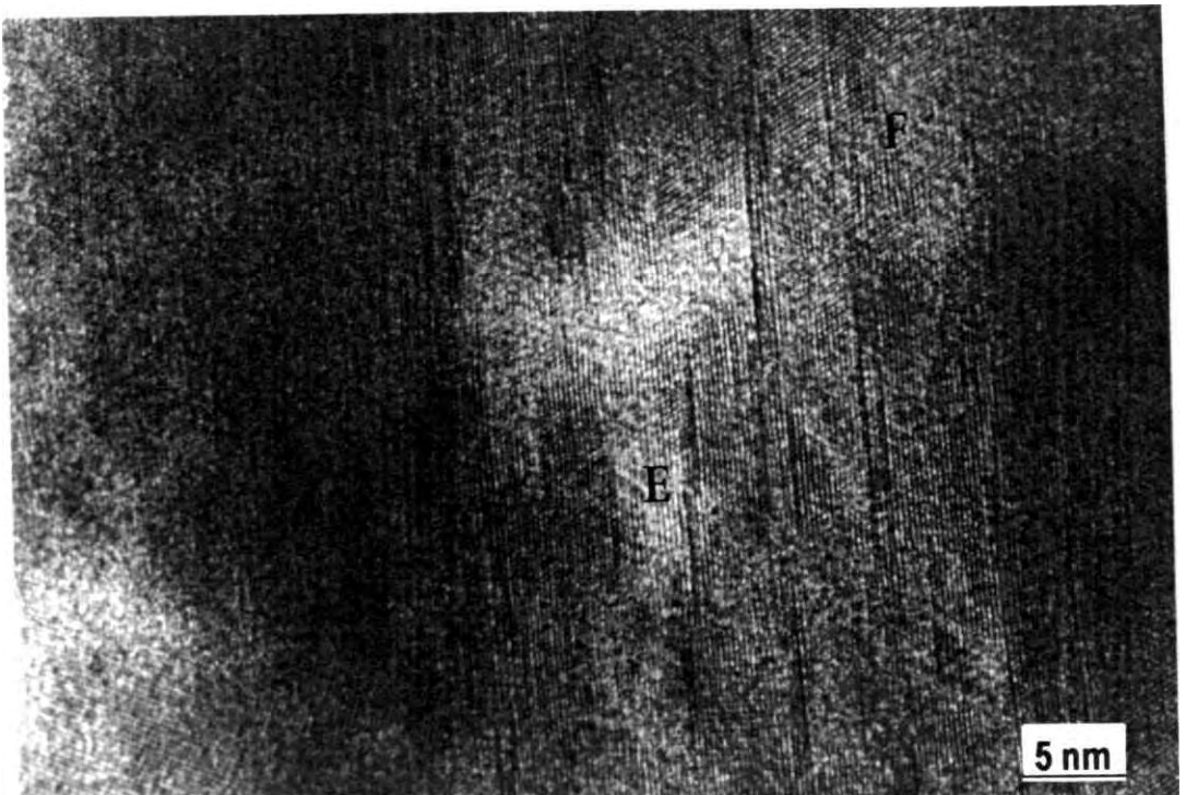
Fig. 3.66-b. Micrografía HREM de ZnO:In/vidrio con 32 % de dopaje, vemos los planos atómicos y otros desaparecen.
