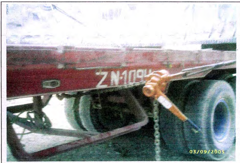
Figura 4.26: La carga se fija con cuatro tecles de 1.5 ton.
